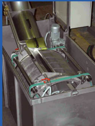
TAMBOR SOPORTADO POR SISTEMA POLEAS FACIL MANTENCION MINIMO DESGASTE
