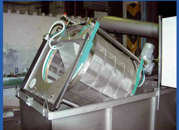
TAMBOR SOPORTADO POR SISTEMA POLEAS FACIL MANTENCION MINIMO DESGASTE
